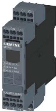
Цифровое реле контроля для контроля тока утечки с дифференциальным преобразователем тока 3UL23 для IO-Link Диапазон настройки 0,03–40 А отдельно для порога предупреждения и значения отключения Задержка запуска и срабатывания 0–999,9 с Гистерезис отключения до 50 % Гистерезис предупреждения 5 % фиксируемый. Ширина 22,5 мм, 2 переключающих контакта контроль рампы торможения (с датчиком или без него) Пружинные клеммы
