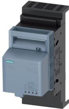
SENTRON, предохранитель-разъединитель 3NP1, 3-пол., NH000, 160 A, для системы сборных шин Rittal 60 мм, рамочн. клемм., устр. контроля предохранителей: электронное устройство EFM 10, плоскость крышки 32/70 мм
