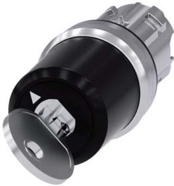
замковый переключатель Siemens, 22 мм, цилиндрической формы, металл, глянцевый, номер замка SSG10, с 2 ключами, 2 коммутационных положения О<I, с самовозвратом, угол коммутации 45°, 10:30 ч/12 ч, извлечение ключа в положении О
