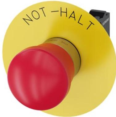
Грибовидная кнопка аварийного останова, 22 мм, кругл., металл, глянцев., цвет: красный, 40 мм, положительная блокировка, согласно DIN EN ISO 13850, разблокировка вытягиванием, с желтой табличкой, Надпись: Not-halt, с держателем, 1 Н3, 1 Н3, пружинная клемма
