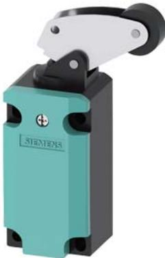
Позиционный выключатель Металлический корпус 40 мм согласно DIN EN 50041 Подключение устройства 1 x (M20 x 1,5) 1 НО/1 НЗ, контакты мгновенного действия Угловой роликовый рычаг, Металлический рычаг и пластмассовый ролик 22 мм
