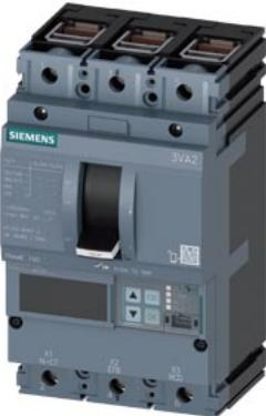
авт. выключатель 3VA2 IEC типоразмер 160 класс коммутационной способности C  $I_{cu} = 110 \text{ kA}$  @ 415 В 3-пол., защита двигателей ETU860M, LSIG,  $I_n = 100 \text{ A}$  защита от перегрузки  $I_r = 40 \dots 100 \text{ A}$  защита от коротких замыканий  $I_{sd} = 1,2 \dots 15 \times I_n$ ,  $I_i = 3 \dots 15 \times I_n$  защита от замыканий на землю, отключающая  $I_g = 0,2 \dots 1 \times I_n$ ,  $t_g = 0,05 \dots 0,8 \text{ с}$  клеммное соединение
