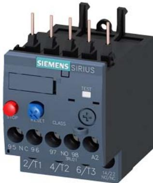
Реле перегрузки 5,5–8,0 А теплов. для защиты двигателя типоразмер S00, класс 10 Для установки на контакторах Главная цепь: винт Вспомогательная цепь: винт Ручной/автоматический сброс
