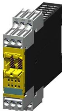
SIRIUS, блок расширения 3RK32 для модульной системы безопасности 3RK3 4 Оу-ЦВых, 24 В DC/2 А возможность параметрирования на MSS ES Установочная ширина 22,5 мм Винтовые зажимы до SIL3 (МЭК 61508) до уровня производительности Е (ISO 13849-1) без соединительного кабеля
