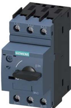
нестандартный вариант автоматический выключатель, типоразмер S00 для защиты трансформаторов расцепитель тока перегрузки 5,5...8 А расцепитель макс. тока 163 А винтовые клеммы стандартная коммутационная стойкость окружающая температура -50°C 500 коммутационных циклов
