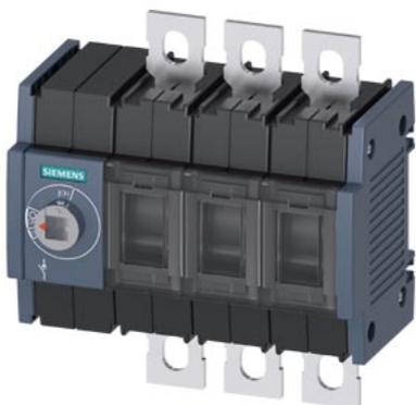
выключатель-разъединитель 160А, типоразм. 2 3-пол. фронтальный привод, левый базовое устройство без рукоятки плоский контакт вкл. межфазные перегородки
