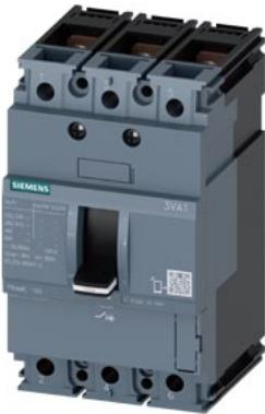
авт. выключатель 3VA1 IEC типоразм. 100 класс коммутационной способности N Icu = 25 kA @ 415 В 3-пол., защита оборудования TM210, FTFM, In = 100 А защита от перегрузки фикс. значение Ir = 100 А защита от коротких замыканий li = 10 x In плоский винтовой зажим
