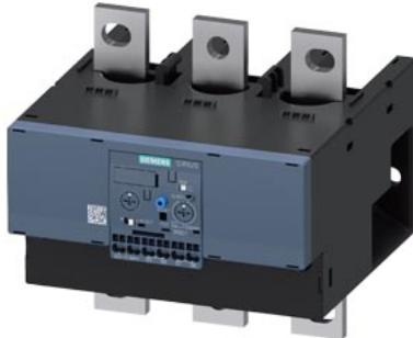
Реле перегрузки 160–630 А для защиты двигателя Типоразмер S10/S12, класс 5–30Е Для установки на контакторах/автономной установки Главная цепь: шинное соед. Вспомогательная цепь: пружинная клемма Ручной/автоматический сброс Внутреннее обнаружение замыкания на землю
