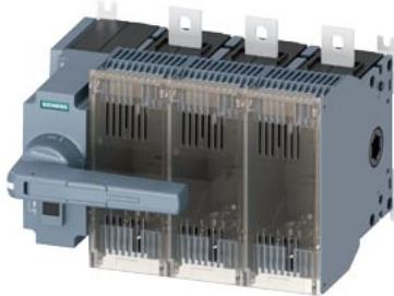
выключатель-разъединитель с предохранителем, 400A, типоразм. 4, 3-пол. для предохранителей NH разм. 1 и 2 фронтальный привод, левый комплектное устройство с прямым приводом серого цвета плоский контакт
