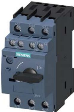
Автоматический выключатель, типоразмер S00 для защиты трансформатора. Максимальный расцепитель тока с обратнозависимой выдержкой времени 0,18–0,25 A. N-расцепитель 5,2 A. Винтовой зажим. Стандартная коммутационная способность с попечечным выключателем вспомогательных цепей 1 НО + 1 НЗ.
