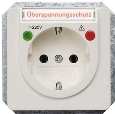
DELTA profil, цвет: титановый белый розетка с защ. контактом 10/16 A 250 В с безвинтовыми соединительными клеммами, с защитой от перенапряжения маркировочное поле, функциональные индикаторы лицевая панель 65 x 65 мм
