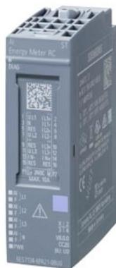
SIMATIC ET 200SP, модуль аналогового ввода - электрический счётчик ~480 В, AI Energy Meter 480V RC ST, со стандартными функциями, для катушек Роговского, трансформаторов тока/напряжения 333 мВ, для установки на базовый блок типа U0, диагностика канала
