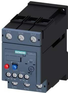
Реле перегрузки 70–80 А теплов. для защиты двигателя типоразмер S2, класс 10A отдельный монтаж Главная цепь: винт Вспомогательная цепь: винт Ручной/автоматический сброс
