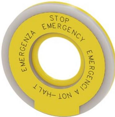
Шайба, круглая, для грибовидной кнопки аварийного останова, цвет: желтый, с подсветкой, толщина 5 мм, наружный диаметр 60 мм, внутренний диаметр 23 мм, с надписью: Not-halt, 4 языка: de, en, it, SP
