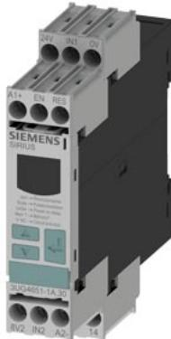
Цифровое реле контроля Устройство контроля скорости вращения от 0,1 до 2200 об/мин Превышение и недостигание 24–240 В AC/DC DC и AC, 50–60 Гц Задержка пуска 1–900 с Задержка срабатывания от 0,1 до 99,9 с Гистерезис от 0,1 до 99 об/мин 1 переключающий контакт, контроль рампы торможения (с датчиком или без него) Винтовой зажим Продукт-преемник для 3UG3051
