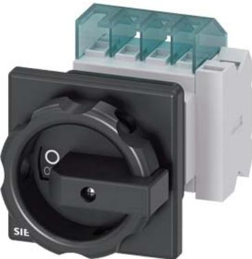
SENTRON, выключатель-разъединитель 3LD, главный выключатель, 4-пол., Iu: 16 A, рабочая мощность/ при AC-23A, при 400 В: 7,5 кВт, фронтальное крепление, 1 НЗ, 1 НО, поворотный привод, цвет: черный, крепление центральной гайкой 22,5 мм для рукоятки
