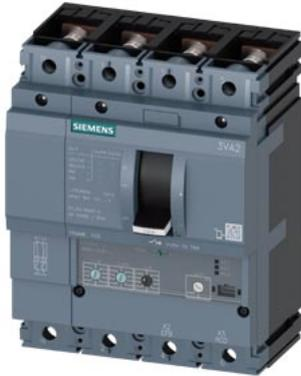
авт. выключатель 3VA2 IEC типоразмер 100 класс коммутационной способности M Icu = 55 кА @ 415 В 4-пол., защита оборудования ETU320, LI, In = 25 А защита от перегрузки I<sub>r</sub> = 10...25 А защита от коротких замыканий I<sub>i</sub> = 1,5...12 x I<sub>n</sub> защита нейтрали регулируемая (ВЫКЛ., 100%) плоский винтовой зажим
