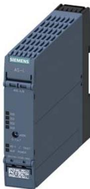
Модуль AS-i SlimLine Compact SC22.5, цифровой, А/В-подчиненный компонент 4 ЦВых, IP20 4 x выход, 2 A, 24 В DC макс. 4 A на все выходы пружинные клеммы Установочная ширина 22,5 мм
