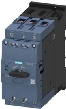
Автоматический выключатель, типоразмер S3 для защиты двигателя, класс срабатывания 10 Максимальный расцепитель тока с обратнозависимой выдержкой времени 45–63 A N-расцепитель 819 A Винтовой зажим Стандартная коммутационная способность с поперечным выключателем вспомогательных цепей 1 НО + 1 НЗ
