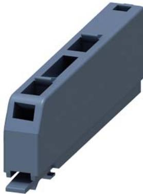
Съемная клеммная колодка, 2-полюсн., втычные клеммники макс. 1 x 4 мм<sup>2</sup> или 2 x 1,5 мм<sup>2</sup>, (в общей оконечной кабельной муфте), для устройства SIRIUS в промышленном корпусе для установки на DIN-рейку
