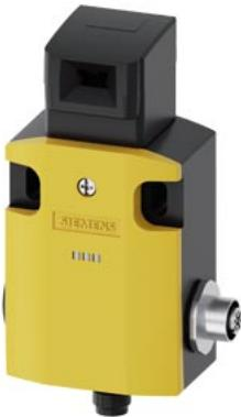
Позиционный выключатель безопасности с отдельным исполнительным механизмом 5 направлений подвода металлический корпус, ширина 56 мм ASI-safe встроено Состояние AS-i: 1:F-IN1, 2:F-IN2 3:AS-i/FAULT Контакты зависимого действия 1 Н3 со штекером M12 4-пол. Канал 1 на Н3, канал 2 на гнездовой контакт M12 справа
