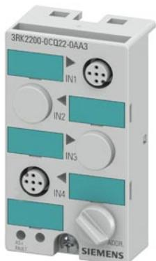
Компактный модуль AS-i K45, цифровой А/В-подчиненный компонент, 4 ЦВх, IP67 2 x 2 входа, макс. 200 mA 2 x розетка M12 с Y-образным расположением выводов Монтажная панель 3RK1901-2EA00 или 3RK1901-2DA00 отдельно
