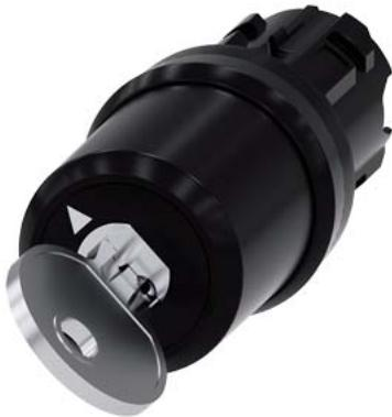
замковый переключатель Siemens, 22 мм, цилиндрической формы, пластмасса, со специальным замком, с 2 ключами, 2 коммутационных положения О-І, с фиксацией, угол коммутации 90°, 10:30 ч/13:30 ч, извлечение ключа в положении О
