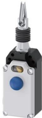
Выключатель с тросовым приводом металлический корпус, 2 x M20 x 1,5; 2 Н3, с фиксацией EN ISO 13850 и кнопочный сброс для длины тросика до 5 м
