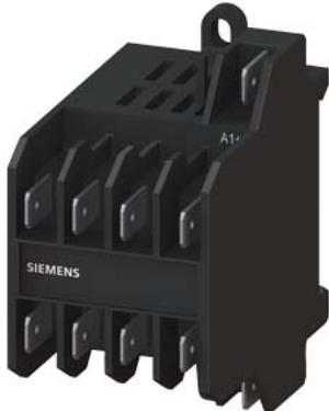
Реле мощности, AC-3 8,4 A, 4 кВт/400 В 4 НО, 24 В AC, 45–450 Гц 3-полюсный, подключение плоским штекером, 6,3 x 0,8 мм
