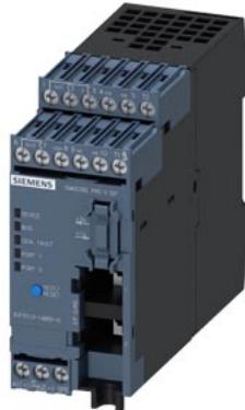
Базовое устройство SIMOCODE pro V EIP, EtherNet/IP, резервирование средств коммуникации DLR, веб-сервер, скорость передачи данных 100 Мбит/с, 2 x подключение шины по RJ45, 4 Bx/3 Вых свободно параметрируемые US: 24 В DC, вход для подключения термистора, моностабильные релейные выходы, расширяется за счет модулей расширения
