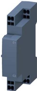
Независимый расцепитель 90–110 В AC, 50/60 Гц, продолжительность включения 100 % 70–190 В AC, 50/60 Гц, продолжительность включения 5 с 70–190 В AC, продолжительность включения 5 с подключением на пружинных клеммах для автоматического выключателя 3RV2
