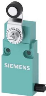
Компактный выключатель с соединительным кабелем 2 м, контакты мгновенного действия 1 НО + 1 НЗ Качающийся рычаг по конструкции аналогичен 3SE3 (предыдущая программа)
