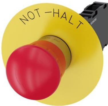
Грибовидная кнопка аварийного останова, 22 мм, кругл., металл, глянцев., цвет: красный, 40 мм, положительная блокировка, согласно DIN EN ISO 13850, поворотный расцепной механизм, с желтой табличкой, Надпись: Not-halt, с держателем, 1 НО + 1 НЗ, винтовой зажим
