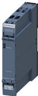
Термисторное реле защиты двигателя, компактный анализатор, корпус 17,5 мм, винтовой зажим, 1 переключающий контакт, US = 24 В AC/DC, автоматический сброс, подходит для биметаллических выключателей, выходное напряжение питания, 1 светодиод (с замкнутыми контактами)
