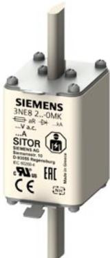
вставка предохранителя SITOR, вкл. ножевые контакты, NH1, In: 200 A, aR, Un AC: 690 В, Un DC: 440 В, фронт. индикат.
