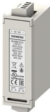
ATC6, модуль расширения 2DI/2DO SSR, принадлежность для ATC6300 и ATC6500; втычн. содержит 2 цифровых входа и 2 пригодных для электронных устройств цифровых выхода 2 НО
