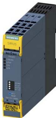
Предохранительное устройство SIRIUS Базовое устройство серии Advanced Размыкающие цепи реле 3 замыкающих контакта плюс сигнальная цепь реле, 1 размыкающий контакт  $U_s = 24$  В DC Пружинная клемма (Push-In)
