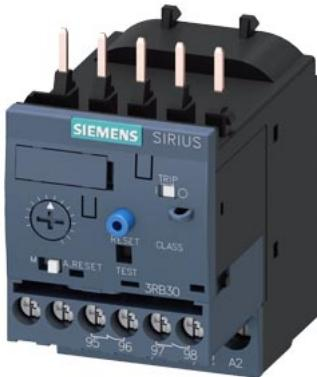
Реле перегрузки 4–16 А электронн. для защиты двигателя Типоразмер S00, класс 2 НЗ Для установки на контакторах Главная цепь: винт Вспомогательная цепь: винт Ручной/автоматический сброс
