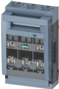
SENTRON, предохранитель-разъединитель 3NP1, 3-пол., NH1, 250 A, для системы сборных шин 8US 60 мм, плоский контакт, плоскость крышки 32/70 мм
