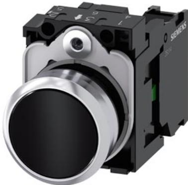
Кнопочный выключатель, 22 мм, кругл., металл, глянцев., цвет: черный, кнопка, плоск., нажатием на кнопку, с держателем, 1 НО, винтовой зажим
