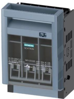
SENTRON, предохранитель-разъединитель 3NP1, 3-пол., NH000, 160 A, для поверхностного и внутреннего монтажа на монтажной панели, рамочн. клемм., плоскость крышки 45 мм
