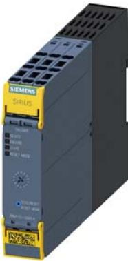
Безопасный пускатель прямого пуска, 3RM1, 500 В, 0–0,12 кВт, 0,1–0,5 А, 110–230 В AC, подключение на пружинных клеммах
