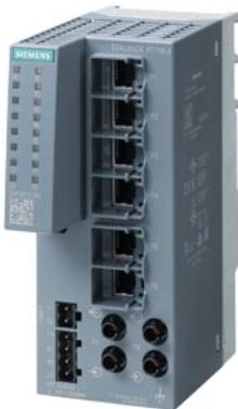
SCALANCE XC106-2 промышленный неуправляемый коммутатор Industrial Ethernet, 6x портов 10/100 Мбит/с RJ45, 2x порта 100 Мбит/с с многомодовым BFOC разъемом, светодиодная индикация, контакт сигнализации ошибки с кнопкой установки, резервированное питание 24В, электронное руководство доступно для загрузки
