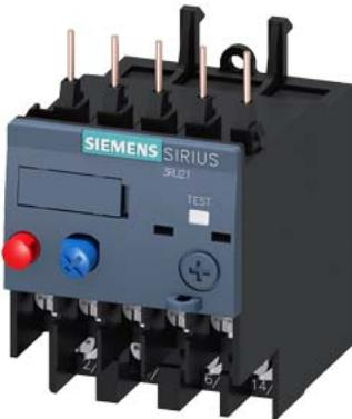
Реле перегрузки 5,5–8,0 А теплов. для защиты двигателя типоразмер S00, класс 10 Для установки на контакторах Главная цепь: глухой кабельный наконечник Вспомогательная цепь: глухой кабельный наконечник Ручной/автоматический сброс
