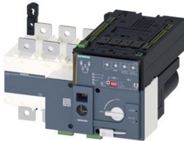
SENTRON, ATE, сетевой переключатель 3КС, авт., ATSE, 3- пол., Iu: 400 A, Ue AC: 415 В, Ie при AC-33В, при 415 В: 200 A, Ie при AC-23A, при 690 В: 125 A, винтовое крепление, моторизованный привод, правосторонний, длинная поворотная рукоятка, шинное соединение
