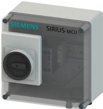
Пускатель электродвигателя SIRIUS MCU Степень защиты корпуса IP55, пластмасса Коммуникация, отсутствует электромеханическое переключение Защита от коротких замыканий с автоматическим выключателем Реверсивный пускатель Тормоз, отсутствует Класс мощности 10,00 А Силовой защитный выключатель двигателя биметаллич., термич. Ручное управление без Силовое подключение, резьбовое M-соединение Стандартное изделие
