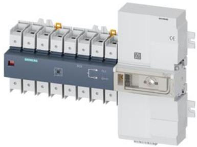
SENTRON, ATE, сетевой переключатель 3КС, авт., ATSE, 4- пол., I<sub>u</sub>: 80 А, U<sub>e</sub> AC: 415 В, I<sub>e</sub> при AC-33В, при 415 В: 80 А, I<sub>e</sub> при AC-23А, при 690 В: 63 А, винтовое и реечное крепление 35 мм, моторизованный привод, правосторонний, длинная поворотная рукоятка, рамочная клемма
