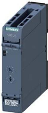
Реле времени, электронн. с задержкой отпускания без управляющего сигнала или с безопасным срабатыванием и скользящим включением с нулевой защитой 7 диапазонов времени 0,05–600 с 24 В AC/DC, 2 переключающих контакта со светодиодом, пружинная клемма (Push-In)
