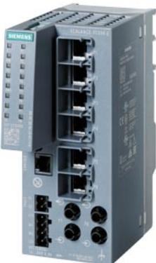
SCALANCE XC206-2 промышленный управляемый IE коммутатор 2-го уровня; 6x электрических RJ45 портов 100 Мбит/с; 2x оптических ST/BFOC порта 100 Мбит/с; 1x консольный порт; светодиодная индикация; резервированное питание 24В; расширенный температурный диапазон (от -40°C до +70°C), монтаж на DIN-рейку/S7 профильные рейки/стену, офисные функции (RSTP, VLAN, ...); PROFINET IO устройство; Ethernet/IP-совместимость; слот для C-plug модуля.
