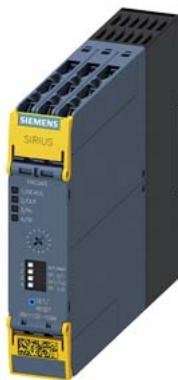
Предохранительное устройство SIRIUS Базовое устройство серии Advanced с задержкой 5–300 с электронные цепи размыкания 2 НО, без задержки 2 НО, с задержкой Us = 24 В DC Винтовой зажим
